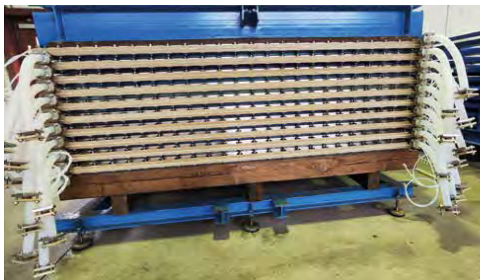
Endabnahme der fertiggestellten Elemente durch den Bubble-Test (Druckprüfung)
