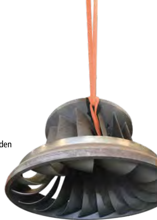
Turbinenlaufräder wirken massiv, brauchen für optimale Leistung aber millimetergenaue Feinabstimmung
